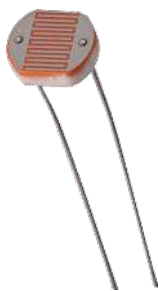
Figura 8 – Sensor passivo LDR que capta a luminosidade no local. Retirado de ( ARDUINOLANDIA, 2018 ).
