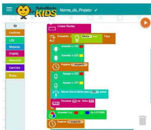
Figura 1 – Exemplo de programa desenvolvido na linguagem gráfica DB4K, no ambiente DB4k onde as diferentes cores, na divisória esquerda, representam diferentes tipos de ações. À direita o usuário arrasta e insere os blocos em sequência ou sobre outro bloco, como parâmetro, para desenvolver o algoritmo. Retirado de (QUEIROZ; SAMPAIO; SANTOS, 2016).
