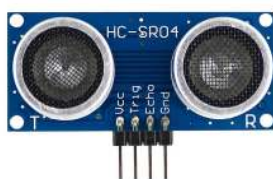
Figura 9 – Sensor ativo HCSR04 medidor de distância. Calcula a distância a outros objetos por meio do envio de ondas ultrassônicas. Retirado de ( ROBOCORE, 2018 ).
