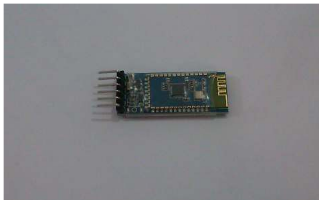
Figura 20 – Módulo Bluetooth HC-06
